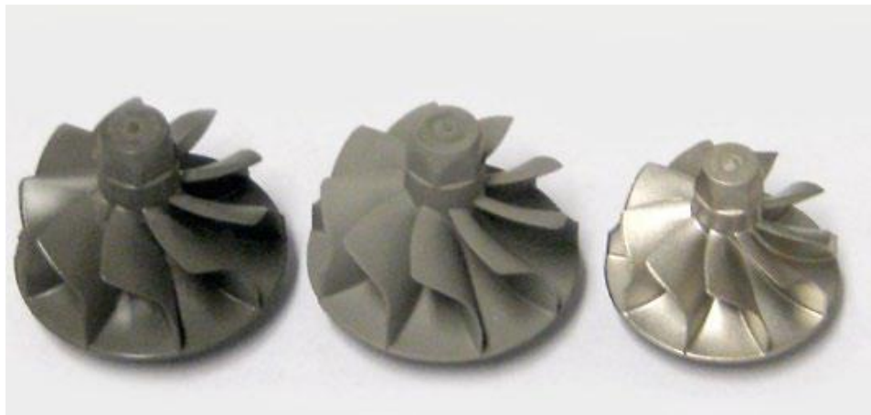
Рисунок 1.6 – Зеленое (слева), коричневое (в центре) и спеченное (справа) колесо турбокомпрессора, полученное из сплава IN713LC (Schunk Sintermetalltechnik GmbH) [11]
