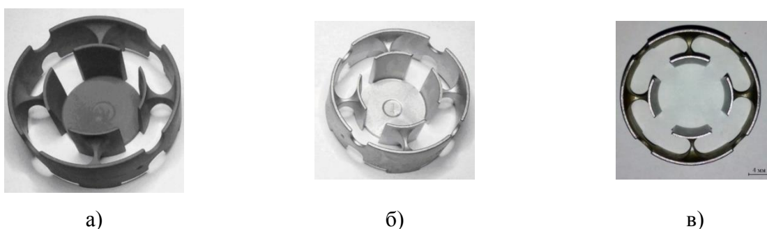
Рисунок 3.2 – Внешний вид: а) – зеленой заготовки детали; б) – спеченной заготовки детали; в) – конечной детали «Втулка центрирующая», изготовленных МИМ-методом
