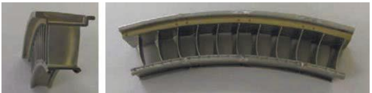
Рисунок 1.8 – Спеченные образцы MIM лопасти, изготовленные из сплава MIM 718 [16]
