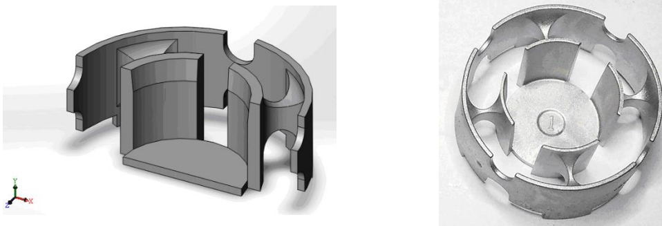
Рисунок 2.2 – Внешний вид заготовки детали «Втулка центрирующая», изготовленной МИМ-методом из аналога стали 38ХМА
