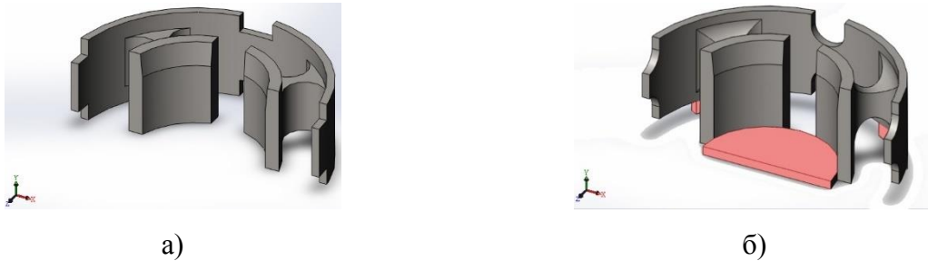
Рисунок 3.4 – Внешний вид детали: а) – требуемая деталь; б) – МИМ-деталь с изменениями: опорой для спекания
