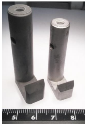
Рисунок 3.16 – Внешний вид зеленой детали-отливки и готовой спеченной детали «Фиксатор», изготовленных МПМ-методом
